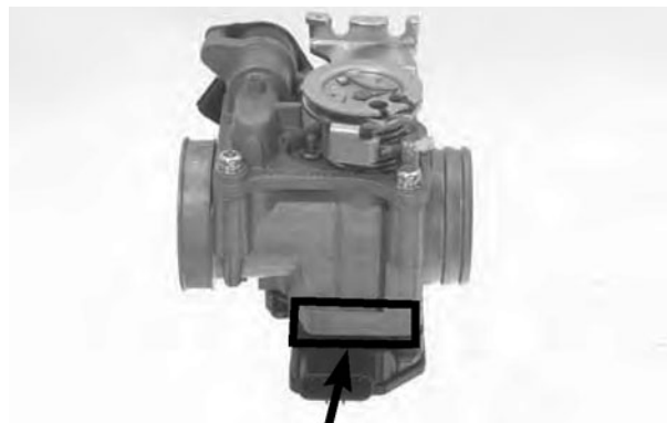
NÚMERO DE IDENTIFICAÇÃO DO CORPO DO ACELERADOR
